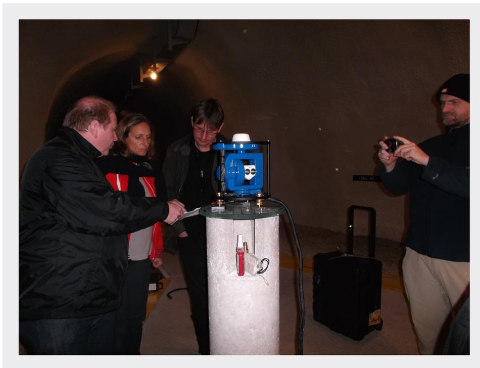
Figure 24: Échange de vues entre des scientifiques du ZAMG et Ir. Bracke de l'IRM lors de l'installation de l'AUTODIF. Le boîtier bleu protège l'instrument de la poussière et de l'humidité.
