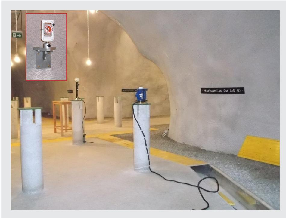
Figure 23: Détails de l'installation. L'insert montre un "corner cube" éloigné de 50m de l'AUTO-DIF, qui réfléchit le rayon laser que l'AUTODIF émet. Cela sert de référence directionnelle.
