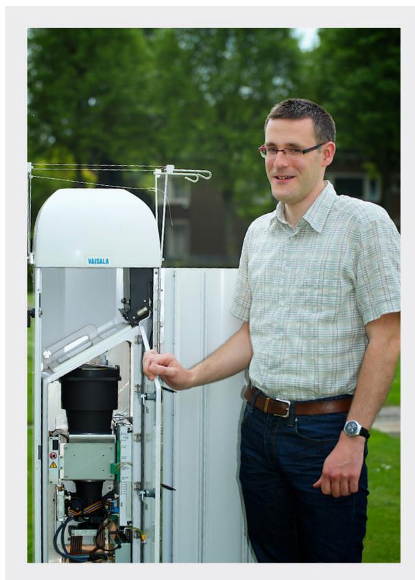
Figure 25 : Un ceilomètre-lidar
